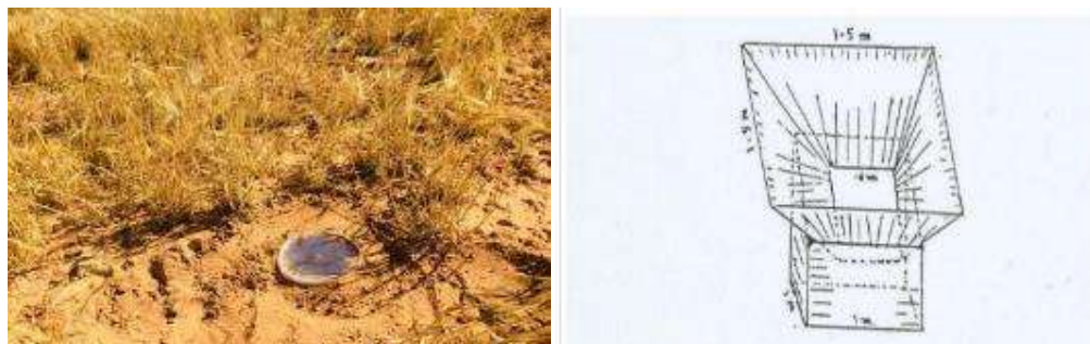
شكل (6) مخطط لآحد نماذج مصائد الرمال (Troeh et al, 1980) والنموذج المعدل بواسطة الباحث في الحقل
